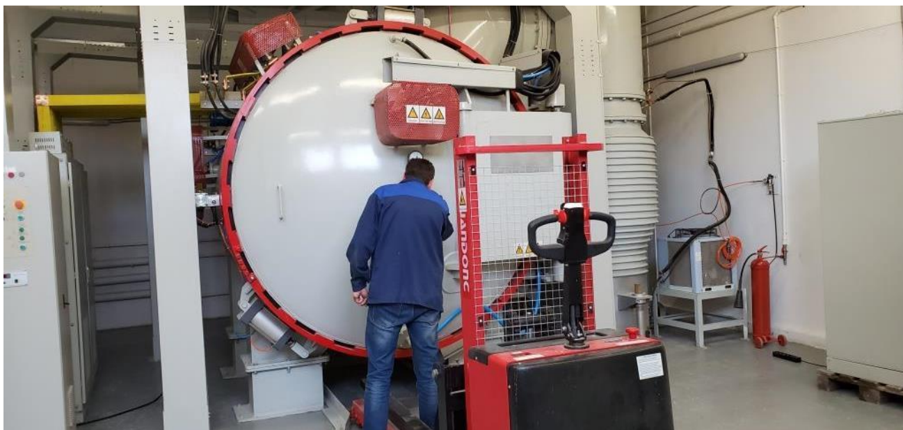
Рисунок 2. Конструкционная пайка датчиков кориолисовых расходомеров в высокотемпературной вакуумной печи на заводе ЭлМетро
