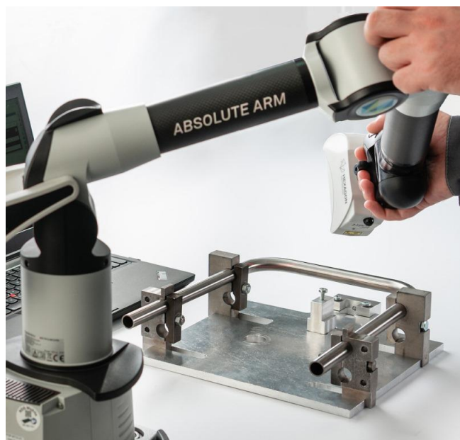
Рисунок 3. Контроль геометрии измерительных трубок 3-d координатно-измерительной установкой на заводе ЭлМетро
