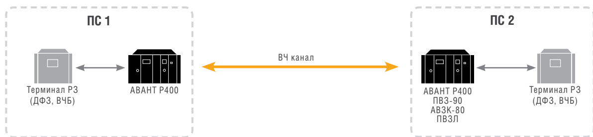
Рисунок 1. Канал связи для высокочастотных защит «точка-точка»
