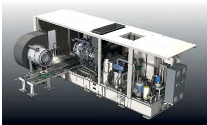
Боковая выкатка силовой турбины из-под кожуха
